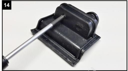
Stechen Sie mit einem spitzen Gegenstand ein kleines Loch durch die Stelle, an der Sie das Kabel hindurchziehen möchten.
