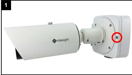
Lösen Sie die Schraube, um die Anschlussbox öffnen zu können.
