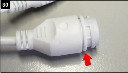
Die Dichtung muss vollständig aufliegen.
