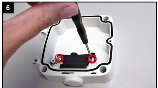
Verwenden Sie einen Schraubendreher und lockern Sie mit wei bis drei Umdrehungen die beiden Schrauben an der schwarzen Platte. Sie brauchen die Schrauben nicht komplett herauszehen.
