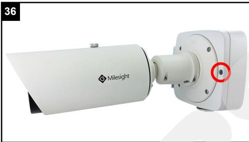
Verschließen Sie die Anschlussbox. Nehmen Sie hierzu den Torx-Schraubendreher aus dem Verpackungsinhalt der Anschlussbox und ziehen Sie die seitliche Schraube feste an.
