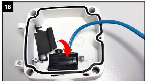
Schwenken Sie die schwarze Platte zurück auf die Dichtung und ziehen Sie die beiden Schrauben wieder fest.
