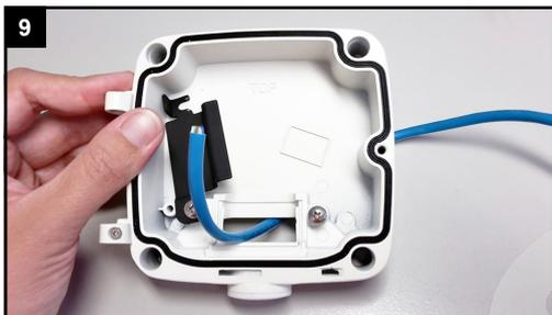
9 Ziehen Sie die Verkabelung durch die Rückseite der Anschlussbox.
