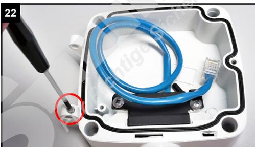
Lösen Sie die Schraube am Scharnier der Anschlussbox.
