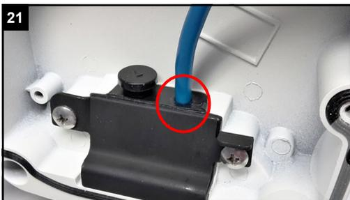
Wenn möglich verwenden Sie etwas Dichtungsmittel, um die Stelle zusätzlich abzudichten, damit keine Luftfeuchtigkeit in die Anschlussbox gelangen kann.
