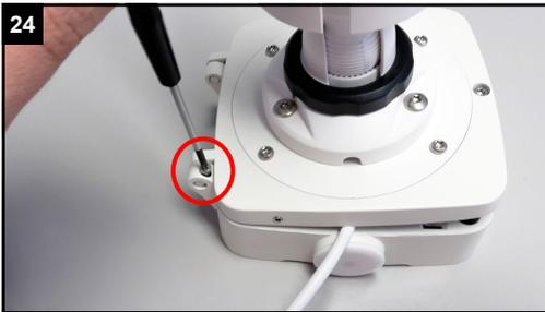
Klappen Sie den Deckel leicht zu, ohne die Verkabelung zu beschädigen. Schrauben Sie die Schraube für das Scharnier wieder ein. Die Schraube verhindert das Lösen des Deckels.
