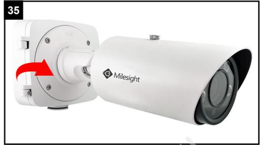
Schließen Sie den Deckel der Anschlussbox. Achten Sie darauf, dass die Verkabelung vollständig in der Anschlussbox ist und dass sich keine Gegenstände zwischen Anschlussbox und Deckel befinden. Dies würde die Dichtheit beeinflussen.
